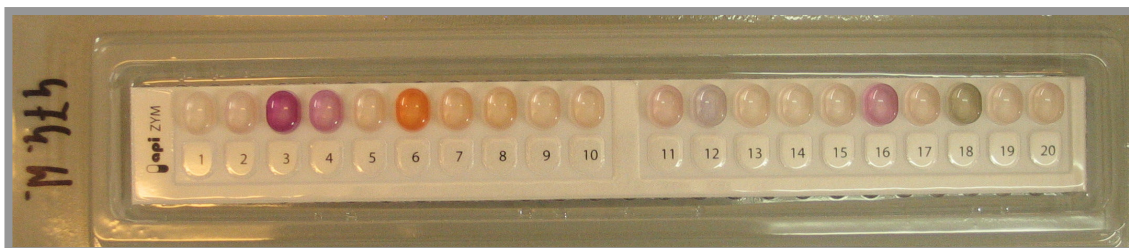
Rycina 14. Oznaczenie profilu enzymatycznego dla szczepu klinicznego C. albicans nr 474 za pomocą testu API ZYM.
