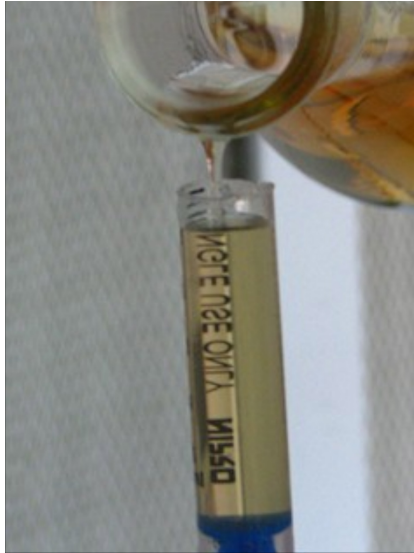
Rycina 1. Przygotowana strzykawka typu Luer wypełniana podłożem bazowym Trypticasein Soy LAB-AGAR™ firmy Biocorp
