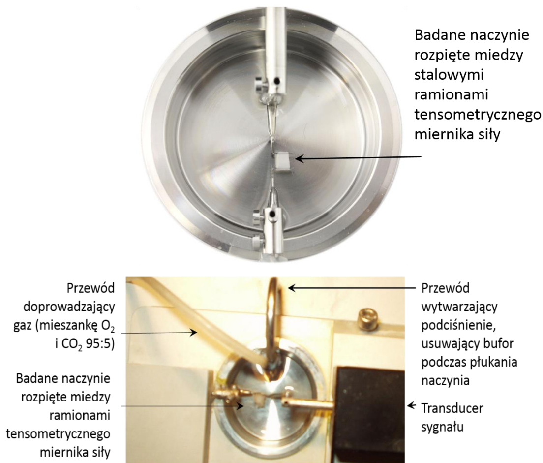
Ryc 4. Schemat łązni naczyniowej ( organ-bath ) z umieszczonym w ramionach tensometru krążkiem naczyniowym
