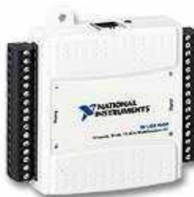
Rycina 7 Karta pomiarowa NI USB-6009 użyta w badaniu.
