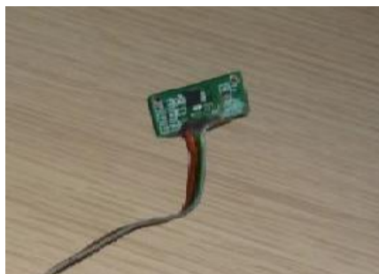
Rycina 6 Czujnik przyspieszenia ADXL 337 użyty w badaniu.
