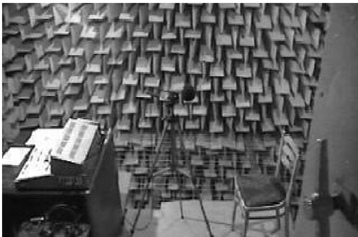
Ryc. 4: Stanowisko nagraniowe w komorze bezechowej
