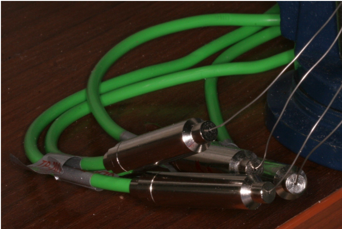
Ryc. 18. Czujniki termopary wykonanej na użytek przeprowadzanych eksperymentów
