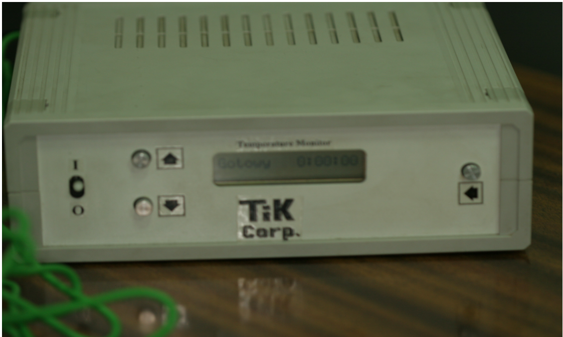
Ryc. 24. Urządzenie do cyfrowej rejestracji temperatury przekazanej z kości poprzez czujniki termopary
