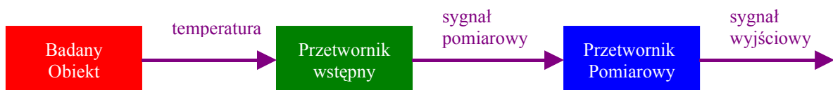
Ryc. 1. Schemat termicznego układu pomiarowego
