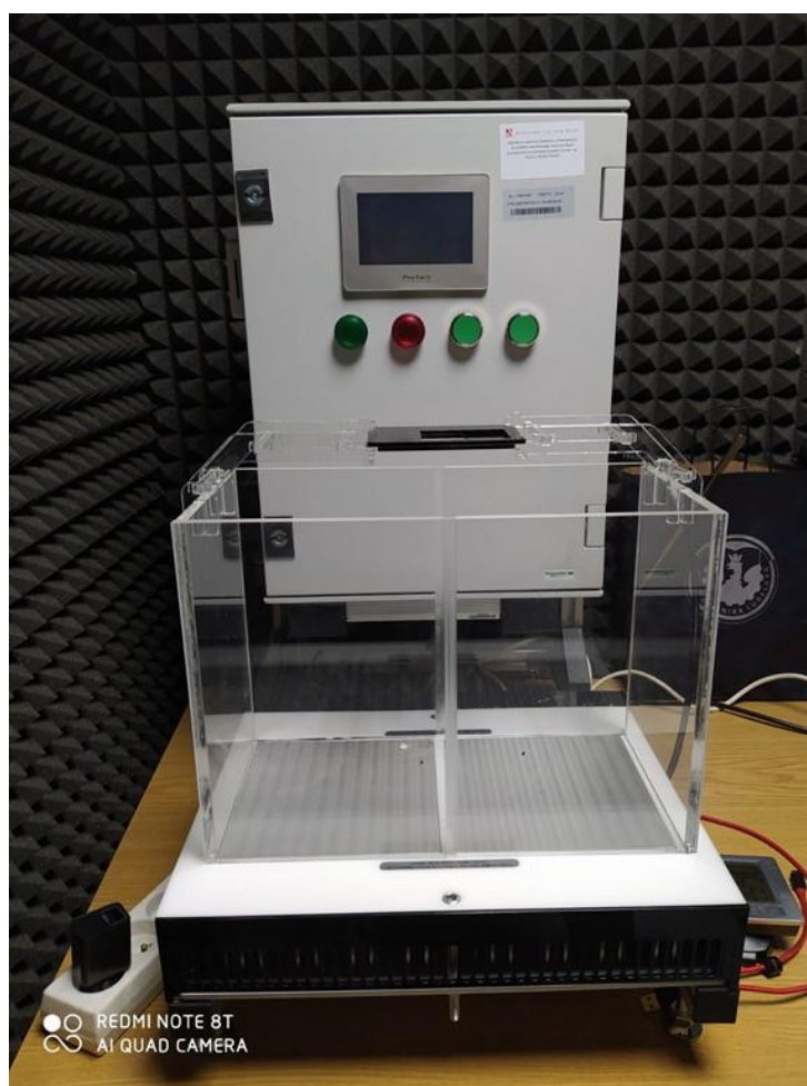
Rycina 50. Prototyp analgezymetru wykorzystanego w eksperymencie do oceny preferencji termicznych zwierząt.
