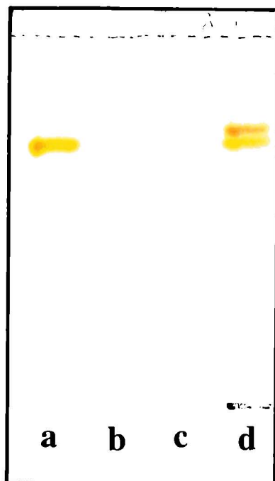
Rys. 45 Chromatogram wyciągów chloroformowych z następujących części morfotycznych Lysimachia vulgaris L.: a – kłącza wraz z korzeniami i rozłogami (zebrane w okresie kwitnienia), b – niekwitające ziele, c – owoc, d – kwiat (płytki pokryte żelem krzemionkowym impregnowane 3% kwasem szczawiowym, faza ruchoma S_{11} )
