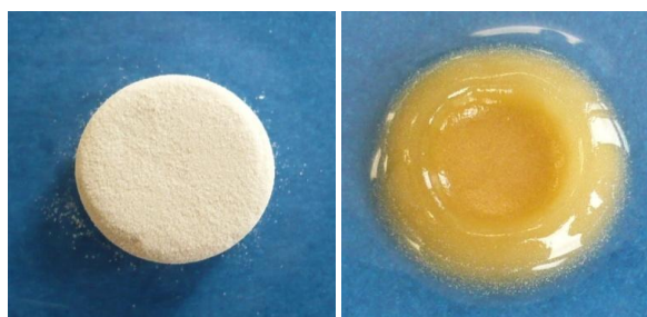
Rycina 1. Przykład tabletki matrycowej przed (po lewej) oraz po hydratacji (po prawej). Zastosowany polimer: alginian sodu.
