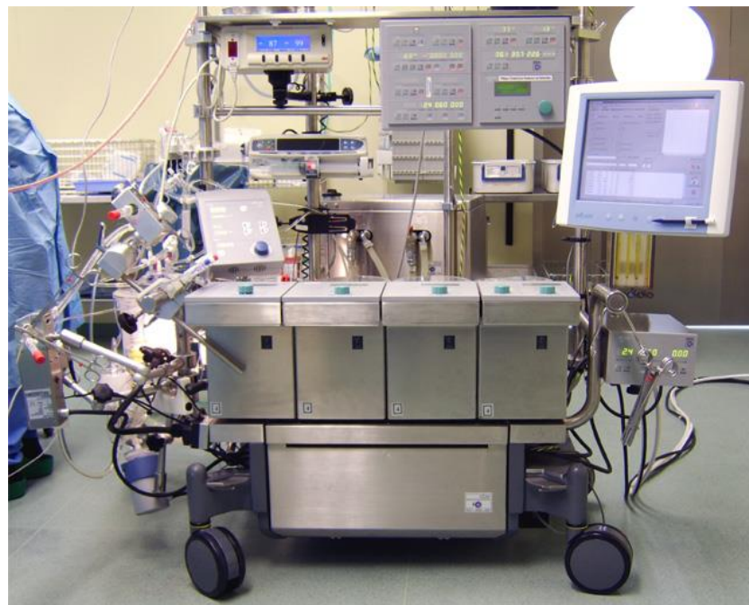
Ryc.2.3.2. Sztuczne płuco – serce. Obecnie stosowany zestaw do prowadzenia krążenia pozaustrojowego. (Perfusion for congenital heart surgery Notes on cardiopulmonary bypass for a complex patient population Gregory S. Matte, Boston, 2015).
