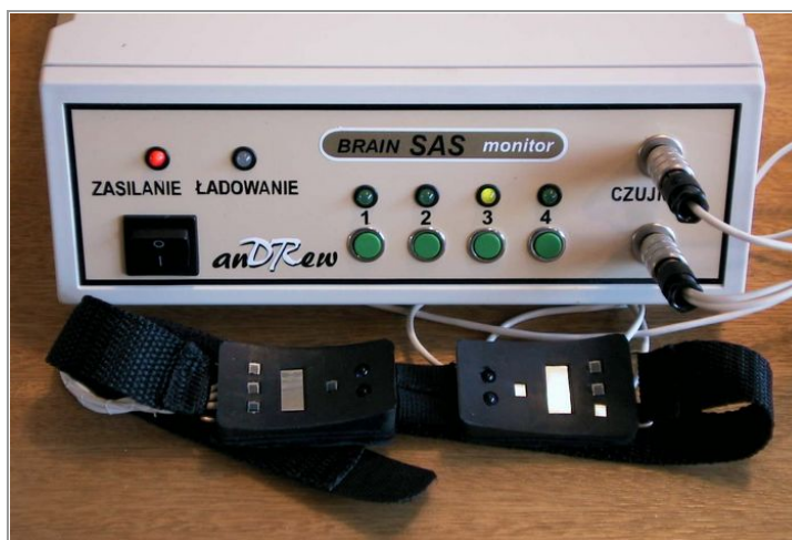
Widok ogólny prototypowego aparatu wraz z sensorami. Przed aparatem znajduje się zestaw nadawczo-odbiorczy w postaci opaski zakładanej na głowę.
