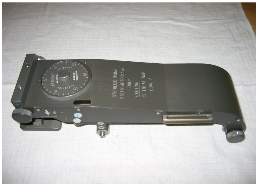
Fot. 4 Urządzenie do pomiaru niestabilności w płaszczyźnie tylny-przedniej artrometr KT-1000/S™
