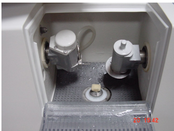
Fot.20.Szlifierka 6-cio osiowa. Widoczne wiertło o kształcie walca i diamentowa tarcza.
