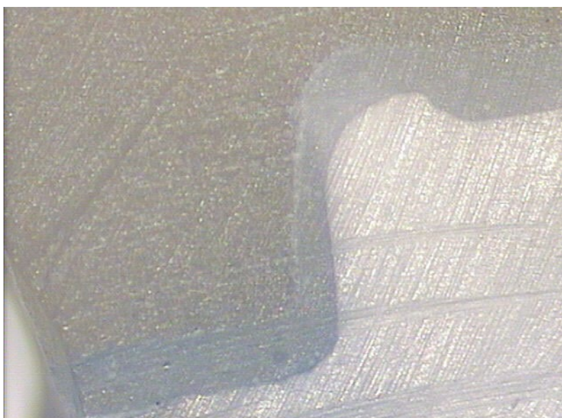
Fot.116. Równomierna warstwa cementu mocującego. Powiększenie 22X, mikroskop optyczny.
